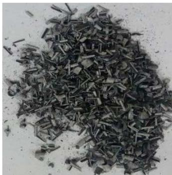
Рисунок 1 - Образец активированного сплава алюминия Al: сплав Вуда (90:10)
